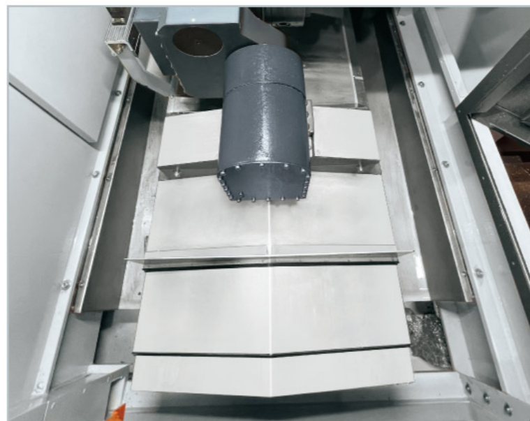
底座加大前排屑傾斜角度
