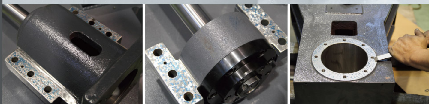
主軸頭端面、三軸馬達支座面及螺桿支座面皆經人工鏟花處理，確保加工精度及進給順暢性。
